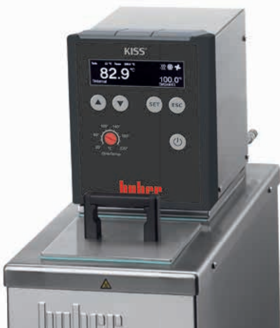
Fig. 3: Os termostatos KISS estão equipados de série com uma interface USB e RS232. Opcionalmente, está disponível de fábrica um conector adicional para um sensor de temperatura Pt100. (No. Cat. 10519).
