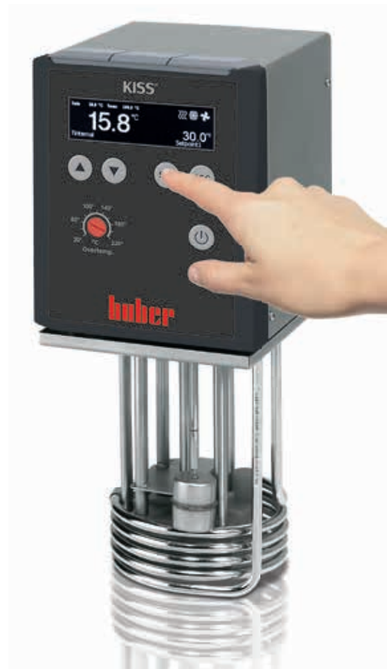
Fig. 2: No novo visor OLED são exibidos de forma clara todos os dados importantes : setpoint, valor real, limites de temperatura, bem como estado de aquecimento, resfriamento e bomba.
