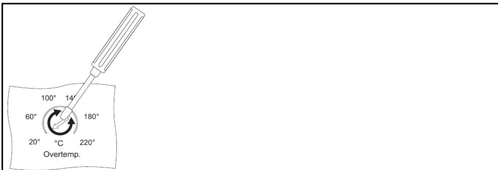
**INFORMATION** Pour régler la valeur de coupure de la protection contre les températures de surchauffe, vous avez besoin d'un tournevis (à tête plate 1,0x5,5).
