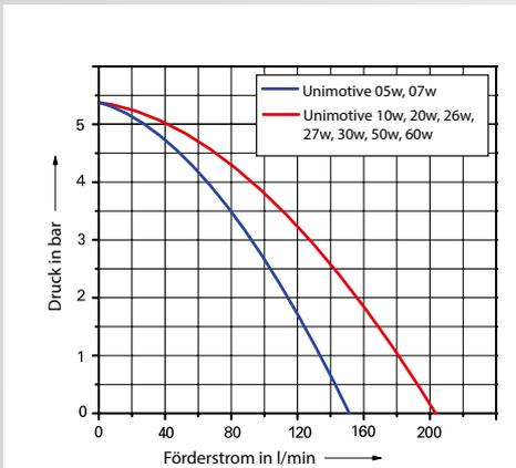
Pumpenlinie nach DIN 12876 mit Wasser bei 20 °C
