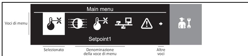
Il menu principale viene richiamato premendo contemporaneamente i >tasti a freccia< [B]. A seconda della dotazione del termoregolatore utilizzato, alcune voci di menu non sono selezionabili.
