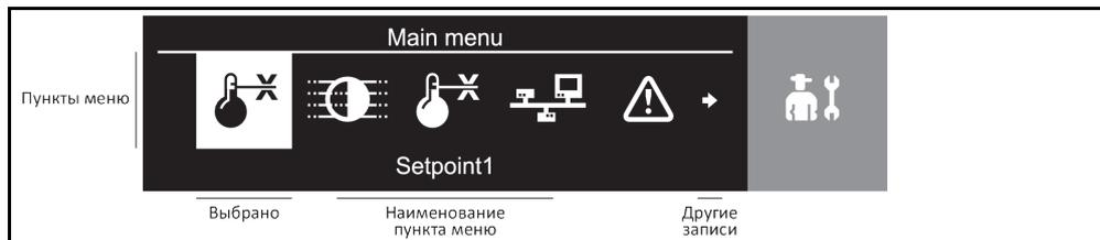
При одновременном нажатии обеих >кнопок со стрелками< [B] вызывается главное меню. В зависимости от оснащения используемого термостата некоторые пункты меню невозможно выбрать.
