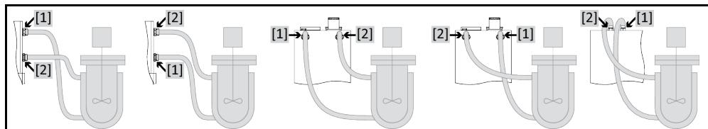
애플리케이터가 올바르게 작동하고 시스템에 기포가 남지 않도록 하려면, 온도 조절 장치의 <순환 출구> [1] 연결부가 애플리케이터의 아래쪽 연결 지점에 연결되고 온도 조절 장치의 <순환 입구> [2] 연결부가 애플리케이터의 위쪽 연결 지점에 연결되는지 확인하셔야 합니다. <팽창 용기> [18] 없는 온도 조절 장치에서 애플리케이터의 하부 연결 지점이 연결부 <순환 입구> [2]와 높이가 동일하거나 본 연결부보다 다소 더 높다는 데 유의하십시오.
