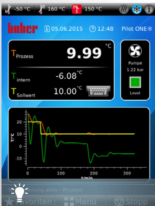
Fig. 1 : Affichage typique sur l'afficheur d'un Unistat® lors d'une régulation de température de processus avec différentes réactions exothermiques constantes.
