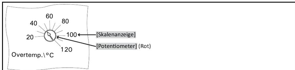
Ein Übertemperaturschutz ist nur in Temperiergeräten eingebaut, die über eine Heizung verfügen. Die Überwachung der Vorlauftemperatur dient der Sicherheit Ihrer Anlage. Sie wird gleich, nachdem Sie die Anlage mit Thermofluid gefüllt haben, eingestellt.
