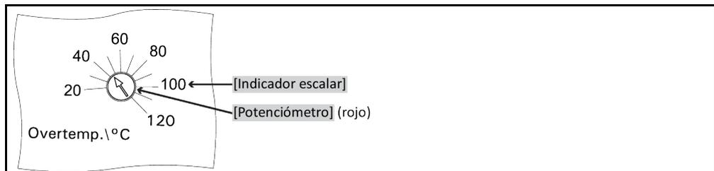
Una protección de sobretemperatura solo está montada en equipos de termostatación que disponen de un calentador. La vigilancia de la temperatura de avance se emplea como seguridad de la planta. Se configura directamente después de haber llenado la planta con el termofluido.
