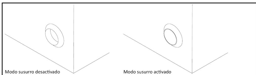
Si se activa el modo susurro en el equipo de termostatación se reduce el nivel de ruido reduciendo la potencia de la bomba. Consulte la posición exacta del interruptor >conmutación régimen de revoluciones de la bomba< [114] en el esquema de conexión a. → A partir de la página 59, el apartado "Anexo".
