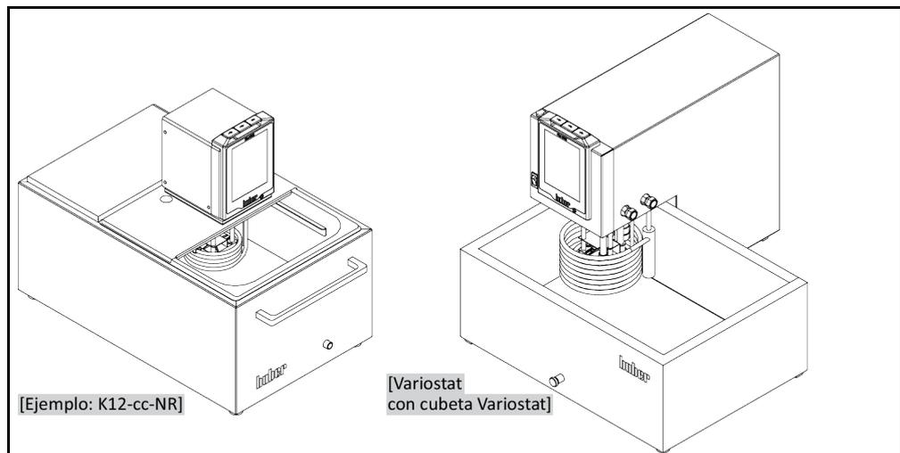
Tenga en cuenta el volumen de fluido expulsado, a causa de una muestra (p.ej. matraz Erlenmeyer). Coloque la muestra cuando el baño todavía esté vacío. Rellene después con suficiente fluido de control de temperatura. Tenga también en cuenta que al extraer la muestras el nivel del fluido bajará. Con el control de la temperatura activo eso puede ocasionar una desconexión de seguridad (protección de nivel inferior). Desconecte por eso el control de temperatura antes de la extracción.
