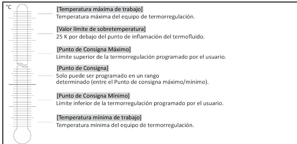
La modalidad de funcionamiento de la protección de sobretemperatura y de la protección de nivel inferior depende del equipo de termostato.
