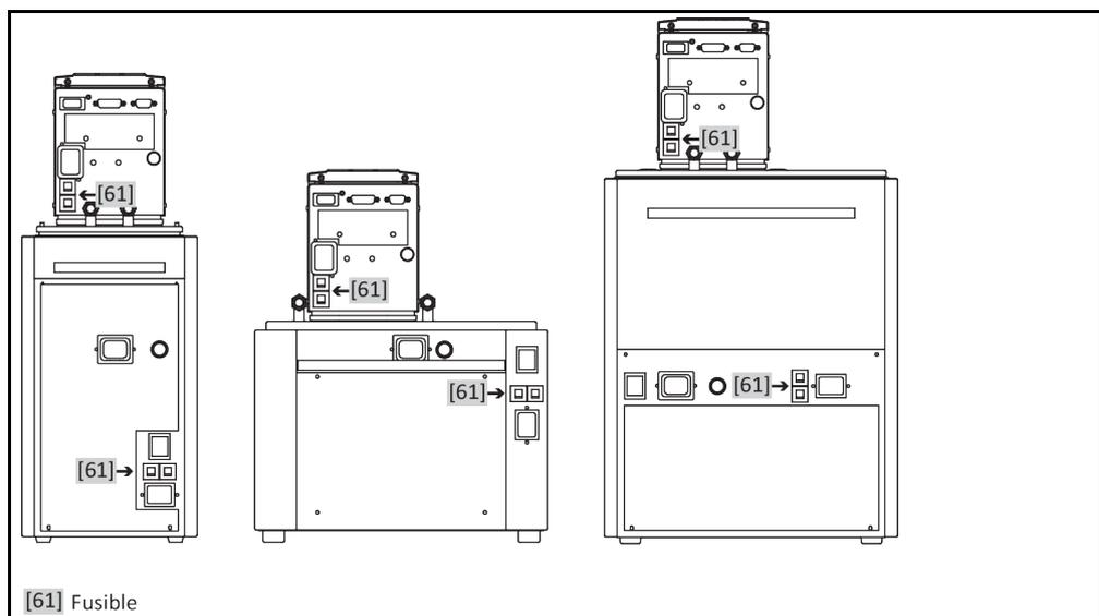
En la parte trasera se encuentran los disyuntores térmicos de sobrecorriente para la desconexión de todos los polos (L y N). En caso de fallo (no funciona ni muestra nada en la pantalla) compruebe primero si se ha activado el disyuntor de sobrecorriente. Si tras revertir se activase sin demora el disyuntor de sobrecorriente, desenchufe y póngase inmediatamente en contacto con el equipo de atención a los clientes. → Página 95, el apartado "Datos de contacto".
