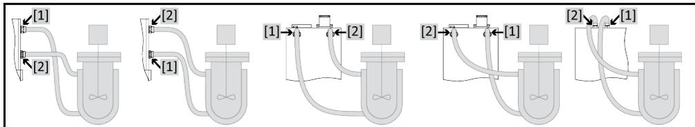
Para poder operar su aplicación correctamente y que no permanezca ninguna burbuja de aire en el sistema, tiene que encargarse de que la conexión **>circulación salida<** [1] del equipo de termostato de regulación esté conectada con el punto de conexión de la aplicación situado más abajo y que la conexión **>circulación entrada<** [2] esté conectada con el punto de conexión situada más arriba de la aplicación en el equipo de termostato de regulación.
