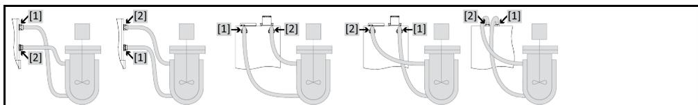
为使您的应用仪器能够正常工作且系统中没有气泡，温度控制器的 >循环出口< [1] 接口必须与应用仪器上位置较低的接口连接而温度控制器的 >循环入口< [2] 接口必须与应用仪器上高度位置相同或更高的接口连接。对于不带 >膨胀容器< [18] 的温度控制器，应确保应用的下方连接点与 >循环入口< [2] 接口处于同一高度或略高于同一高度。
