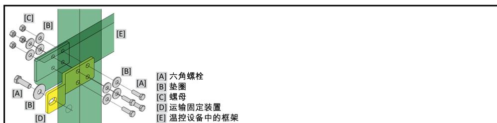
移除温度控制器的侧面保护罩，以便松开或拧紧运输保护装置。
