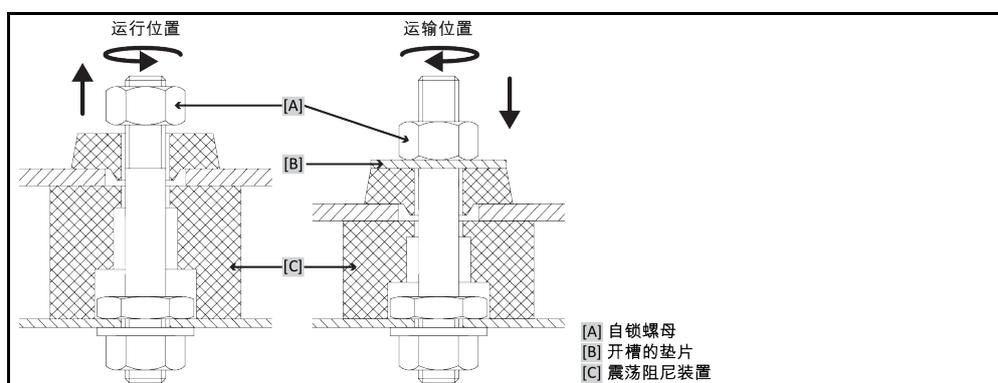
移除温度控制器的侧面保护罩，以便松开或拧紧运输保护装置。
