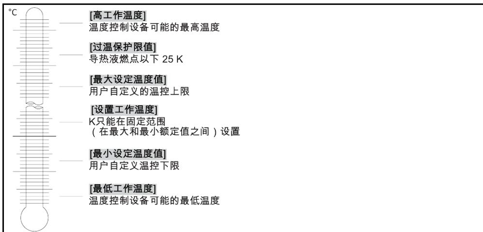
额定值的最小和最大界限可确保您的设备的安全。您必须在第一次温控前及更换导热液时，根据导热液的可使用范围进行设定。额定值最大界限值限制浴槽温度或预流温度的额定值预定值。额定值最小界限值相应地防止在温度较低时粘度过高或冻结。可进行设定的额定值只能处在额定值最大界限值和最小界限值之间的温度范围内。
