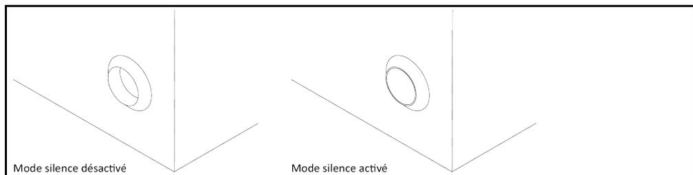
En activant le mode silence sur le thermostat, le rendement de la pompe baisse, entraînant une diminution du niveau sonore. Pour obtenir des informations sur la position exacte de la **>modification de la vitesse de pompe<** [114], consulter le schéma de raccordement. → À partir de la page 59, section »Annexe«.
