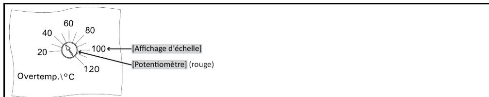
Une protection contre les températures de surchauffe est uniquement intégrée dans des thermostats équipés d'un chauffage. La surveillance de la température de la canalisation montante sert à la sécurité de votre installation. Elle est réglée dès que l'installation a été remplie de fluide caloporteur.
