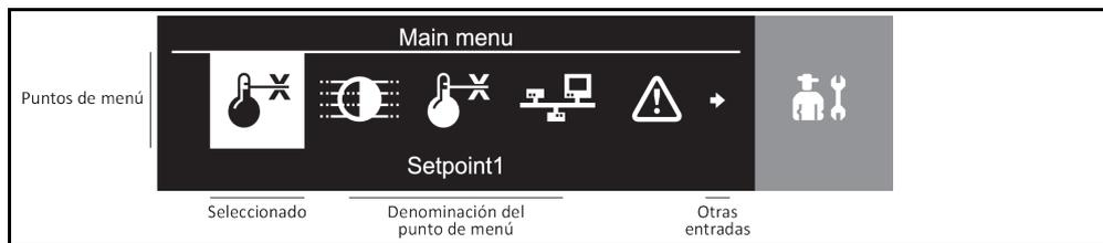
Pulsando simultáneamente las >flechas< [B] se abre el menú principal. En función del equipamiento del equipo de termostato utilizado algunos puntos de menú no están accesibles.
