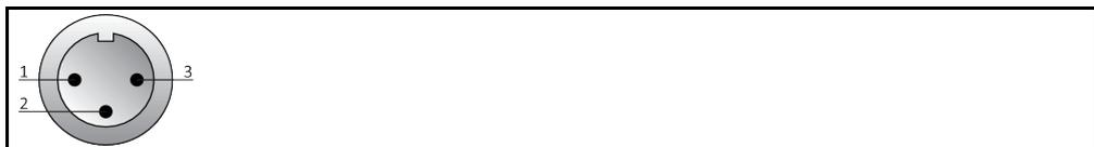
Der Anschluss ist als potentialfreier Wechselkontakt ausgeführt.
