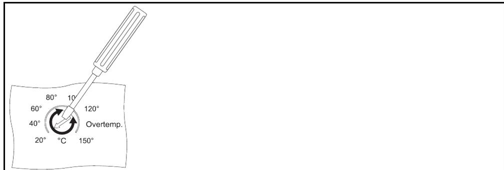
**INFORMATION** Zur Einstellung des Abschaltwertes des Übertemperaturschutzes benötigen Sie einen Schraubendreher (Flachsitz 1,0x5,5).
