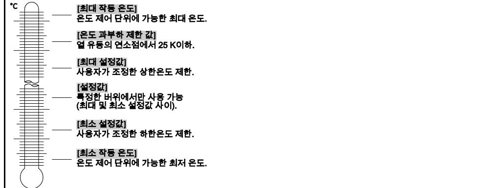
최소와 최대 값의 제한은 귀하의 시스템 안전을 위해서 사용됩니다. 이것은 최초의 온도 제어를 시작전에 또는 열 유동의 교체시에, 열 유동의 장치 범위와 관련하여 설정되어야
