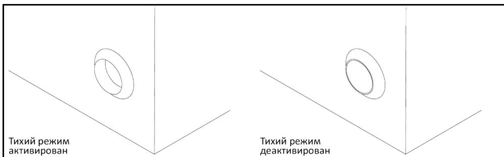
Если на термостате активируется тихий режим, уровень шума снижается за счет уменьшения мощности насоса. Точное положение выключателя **>Изменение числа оборотов насоса<** [114] указано в схеме подключения. → См стр. 84, раздел **»Приложение«**.
