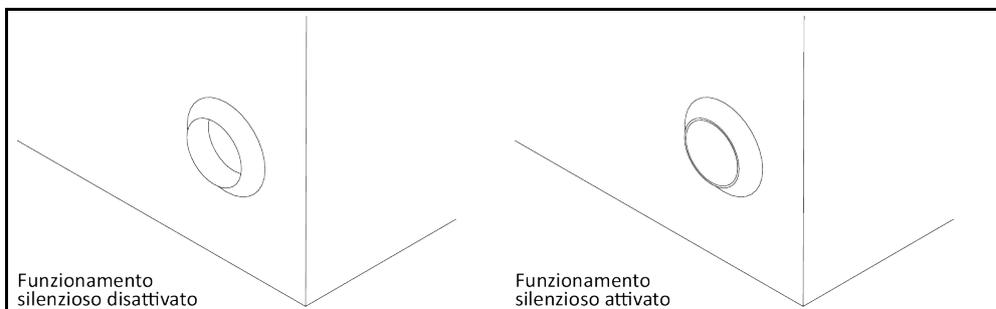
Una volta attivato il funzionamento silenzioso sul termoregolatore, il livello del rumore si abbassa attraverso la riduzione della potenza della pompa. La posizione esatta del pulsante di >modifica numero di giri della pompa< [114] è riportata nella bozza di allacciamento. → da pagina 83 in poi, al paragrafo »Appendice«.
