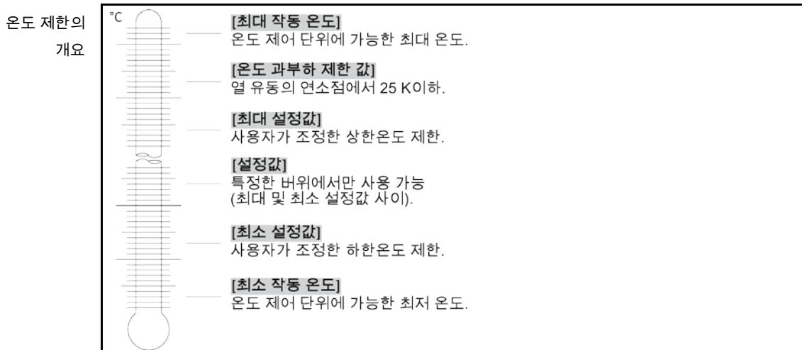
최소와 최대 값의 제한은 귀하의 시스템 안전을 위해서 사용됩니다. 이것은 최초의 온도 제어를 시작전에 또는 열 유동의 교체시에, 열 유동의 장치 범위와 관련하여 설정되어야 합니다. 최대로 원하는 값의 한계 제한은 용기 및 유입 온도의 설정값 입력을 위한 것입니다. 최소 설정값 제한은 지나치게 높은 점성 또는 결빙이 일어나기 전에 낮은 온도에 맞춰서 보호합니다. 설정값은 오로지 최소의 그리고 최대한의 설정값 제한 사이의 온도 밴드에서 가능합니다.
