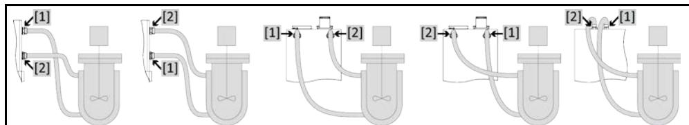
귀하의 장치가 올바르게 작동하고 공기 방울이 시스템에 남지 않도록 하기 위해서, 연결을 확인해야 합니다. >**순환 출구**< [1] 온도 제어 장치에서 밑에 있는 장치의 연결점과 연결된 터미널 >**순환 입구**< [2] 장치의 더욱 높이 놓여있는 연결점에 연결된 온도 제어 장치.
