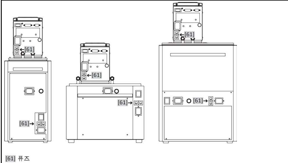
온도 조절 장치의 뒷면에는 모든 폴 분리 용 열 과전류 보호 스위치가 있습니다(L 및 N). 오류 발생 시(기능 없음 및 온도 조절 장치의 표시 없음), 우선 과전류 보호 스위치가 작동되었는지를 확인하십시오. 복귀 후 과전류 보호 스위치가 바로 다시 작동하면, 전원 플러그를 뽑고, 바로 고객 지원 센터(전화번호: 페이지 94 섹션 «연락 정보»)로 연락하십시오.
