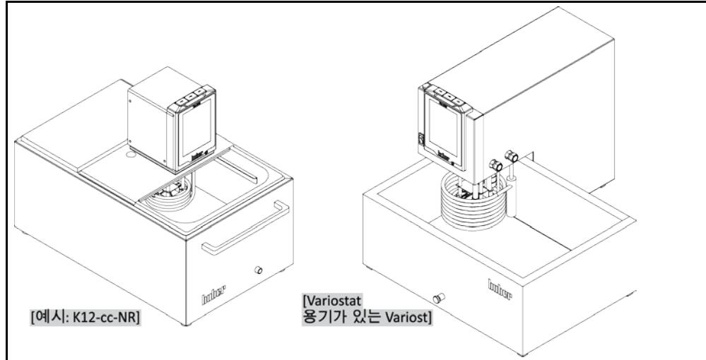
샘플(예. 삼각 플라스크)에 의해 초래될 수 있는 체적 변위에 주의하십시오. 아직 빈 용기에 샘플을 놓으세요. 그런 다음 충분히 온도 조절기액체를 채우십시오. 샘플을 꺼낼 때, 온도 조절기액체 레벨이 내려가는 것에 유의하십시오. 온도 제어조절이 활성화되어 있을 시에, 이것은 안전 종료로 이어질 수 있습니다(저레벨 보호). 따라서, 먼저 온도 제어를 끄십시오.
