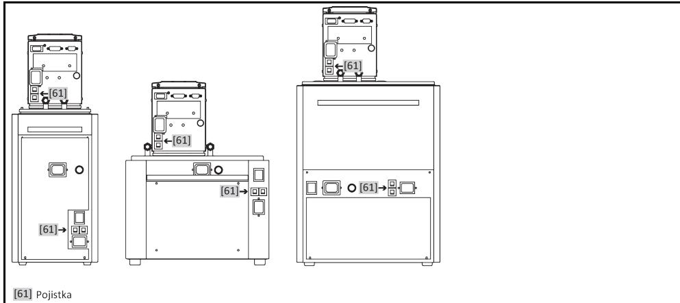
Na zadní straně se nachází teplotní nadproudové jističe pro vypnutí všech pólů (L a N). V případě chyby (nefunguje a/nebo se nic nezobrazuje) prosím nejprve zkontrolujte, zda došlo k aktivaci nadproudových jističů. Pokud by po vrácení nadproudových jističů došlo okamžitě opět k aktivaci, vytáhněte konektor a obraťte se ihned na servisní službu. → Strana 91, odstavec »**Kontaktní údaje**«.
