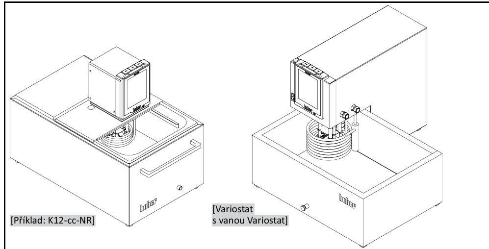
Zohledněte změnu objemu, ke které dojde při odebírání vzorků (např. pomocí Erlenmeyerovy baňky). Vložte baňku do ještě prázdné lázně. Až pak naplňte dostatečné množství temperovací kapaliny. Zohledněte také, že při vyjmutí baňky dojde opět k poklesu hladiny temperovací kapaliny. To může při aktivním temperování způsobit bezpečnostní vypnutí (ochrana dolní úrovně). Proto nejprve vypněte temperování.
