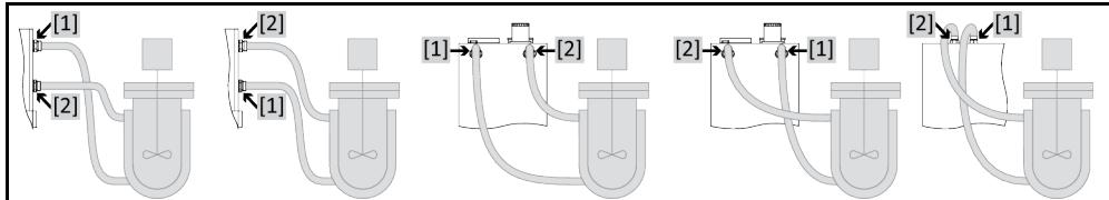
Aby bylo možné správně provozovat vaši aplikaci a v systému nezůstávaly vzduchové bublinky, je nutné zajistit, aby byla přípojka >výstup cirkulace< [1] z temperovacího zařízení propojena s níže ležícím bodem přípojky aplikace a přípojka >vstup cirkulace< [2] do temperovacího zařízení propojena s výše uloženým bodem přípojky aplikace.
