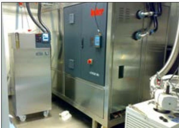
**Ein Unistat 950w temperiert die Vakuumkammer, ein weiterer Unistat 915w den Tisch für die Experimente.**
