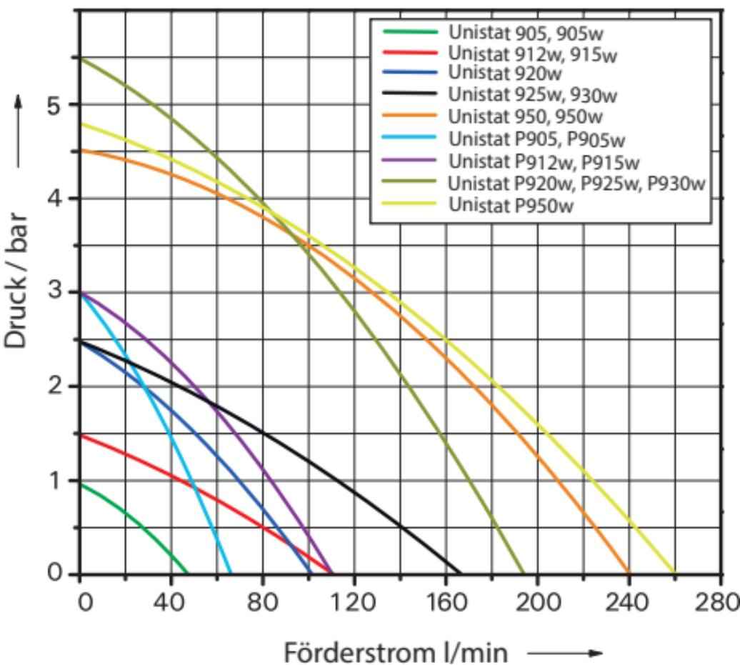
Messung erfolgte nach DIN 12876 mit Wasser bei 20° C
