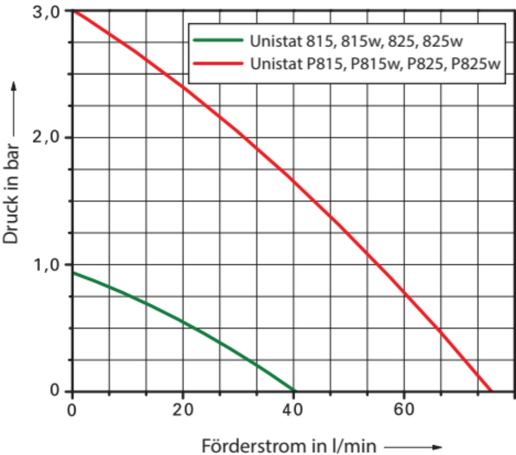
Messung erfolgte nach DIN 12876 mit Wasser bei 20° C
